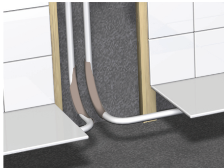
Bild 8. Montering av golvvärmerör i LK Rörböjningsstöd.
