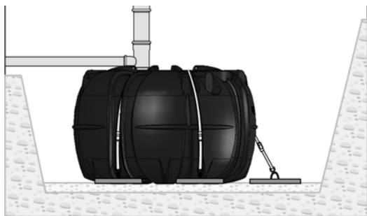
Föranckring med föranckningsplattor.
