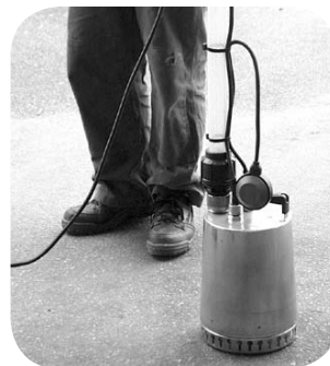
Pumpbrunnen är försedd med ett grönt plastlock. För att låsa locket monteras 2 stycken skruvar typ; borrande självgående M 8 x 30 rostfri som borraras genom locket och fästs i brunnen.
