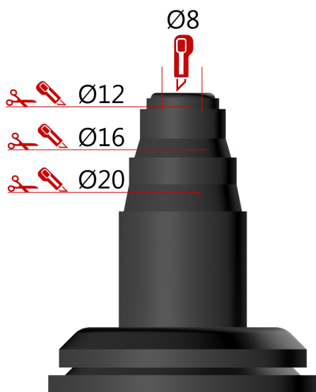
Kapning av rör genomföring.
